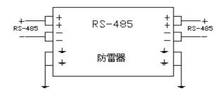
两个 GND 为保护地线,必须将其与设备地一起引接到大地,否则浪涌电流 无处释放,达不到保护效果。
